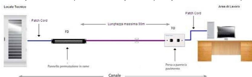
La distribuzione orizzontale identifica quella parte di cablaggio realizzata con cavo in rame a 4 coppie che collega i pannelli di permutazione di piano alle postazioni di lavoro utente mediante connettori modulari di tipo RJ45 per il rame.
