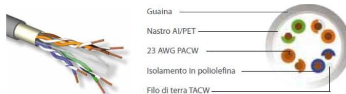
Per la soluzione non schermata Cat. 6A Cavo U/UTP 4 coppie 23AWG 10GPlus HF1 LSZH (codice **AC6U-HF1-500VT**)
